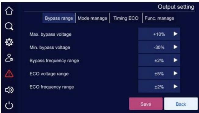
Figura 4-23 Ajuste de la salida
