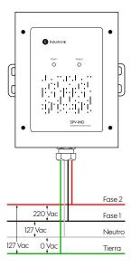
8. Instalación del SPV-IND 2100 en tablero eléctrico.
