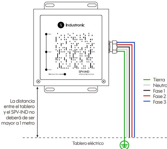
7. Diagrama de cableado del SPV-IND 3000.
