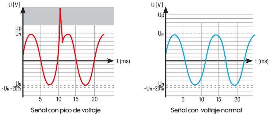
La figura muestra el efecto en la forma de onda de voltaje que realiza el SPVM-IND.
