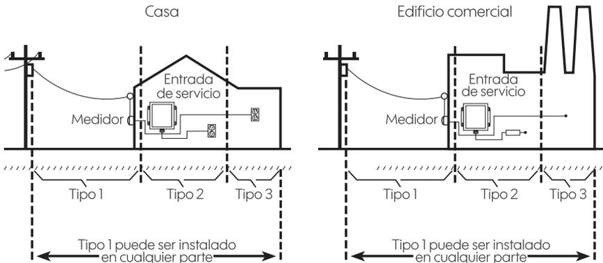
Las imágenes muestran los 3 tipos o clases de supresores de picos definidos según la norma UL 1449. Esta clasificación se especifica con base al punto eléctrico donde el supresor de picos es colocado, así como a los niveles de protección que se requieren en cada punto:
