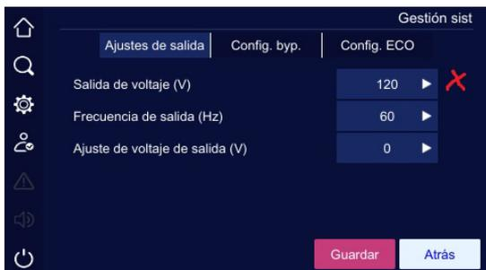
Figura 4-34 Configuración incorrecta
