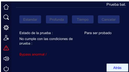
Figura 4-37 Pantalla de prueba de batería
