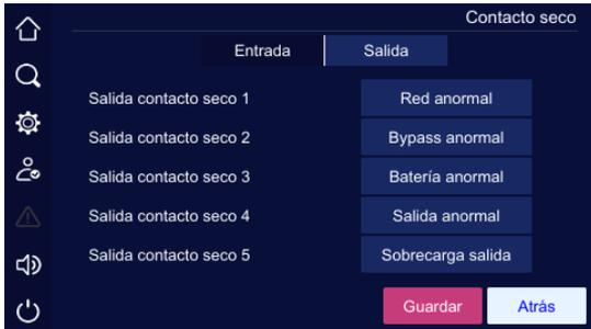
Figura 4-40 Pantalla 1 de configuración de contacto seco de salida
