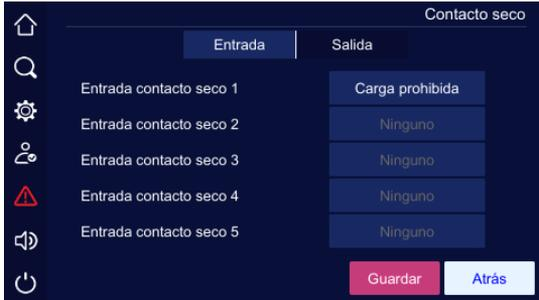
Figura 4-38 Pantalla 1 de configuración de contacto seco de entrada
