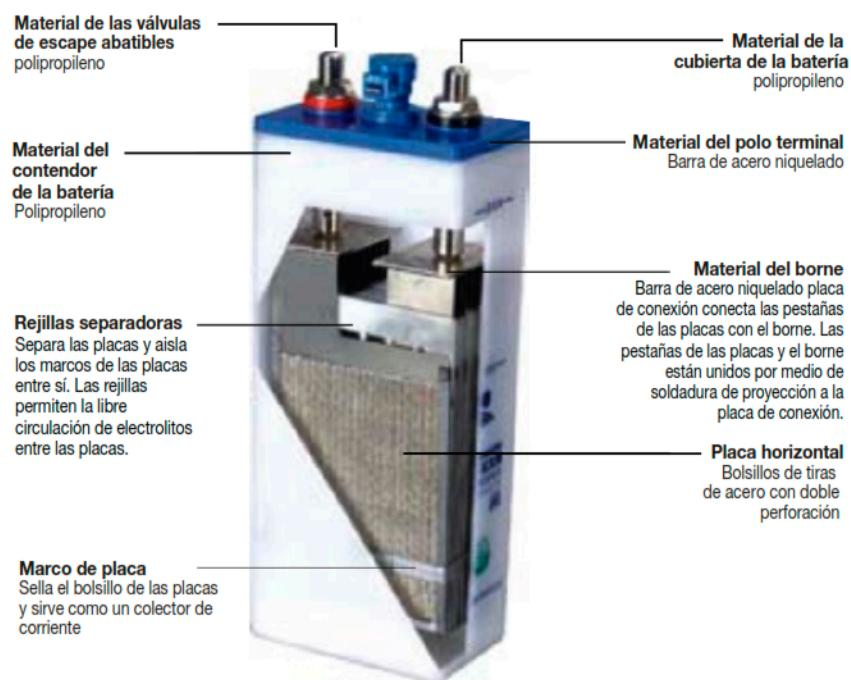
Diagrama esquemático de estructura de la batería Ni-Cd tipo
