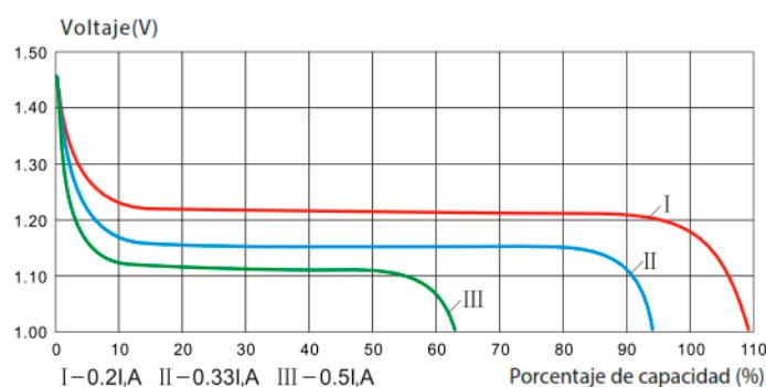
Figura 3 Curva de descarga batería KPL (-18 °C)
