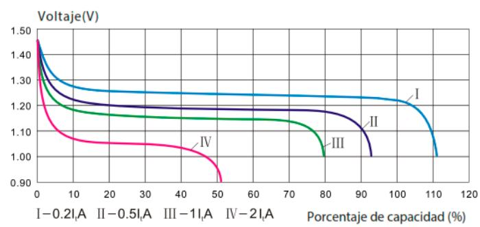
Figura 7 Curva de descarga batería KPM (-18 °C)
