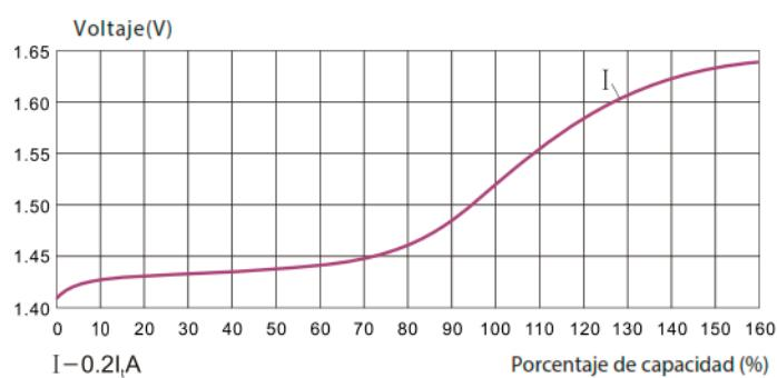
Figura 10 Curva de descarga batería KPH (20°C)
