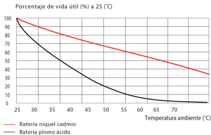
Figura 15 Curvas de comparación de capacidad entre una batería de tipo Ni-Cd de bolsillo y una batería VRLA a diferentes temperaturas
