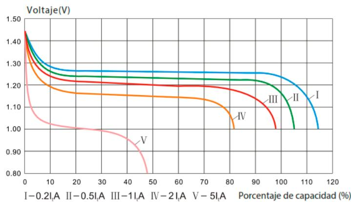
Figura 11 Curva de descarga batería KPH (-18°C)
