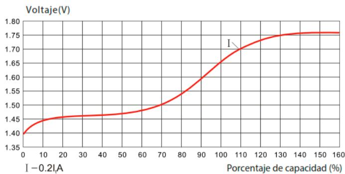
Figura 2 Curva de descarga batería KPL (20 °C)
