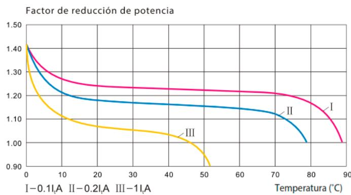
Figura 12 Efecto de la temperatura en KPH
