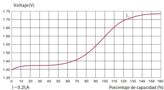
Figura 6 Curva de descarga batería KPL (20 °C)
