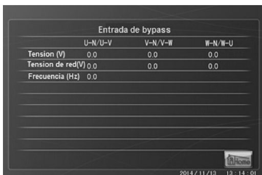
Fig. 4-13 Información de entrada de bypass
