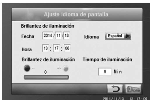
Fig.4-19 Configuración de interfase hombre máquina (HMI)
