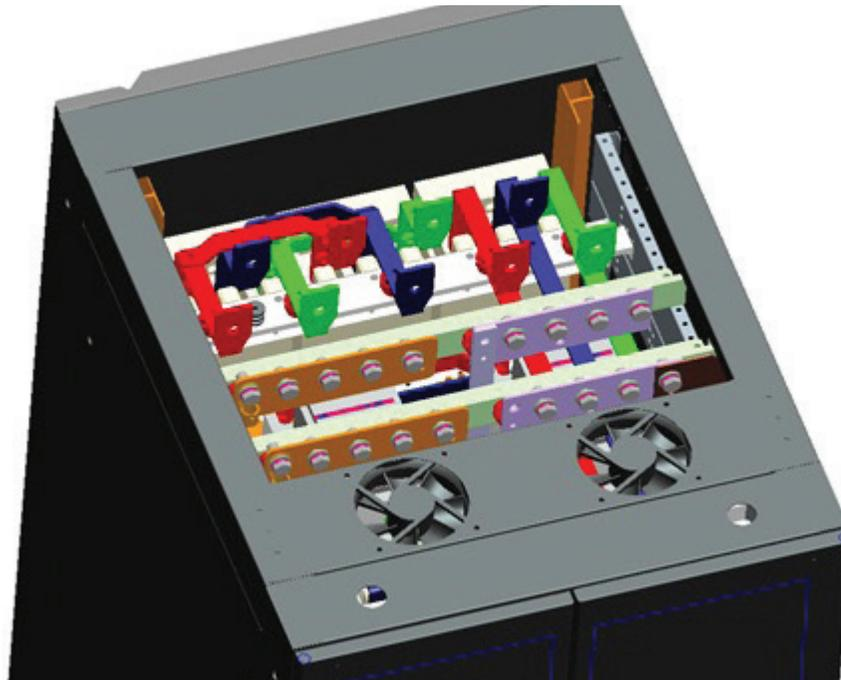
Figura 4-11 Bloque de conexión reservado 1
