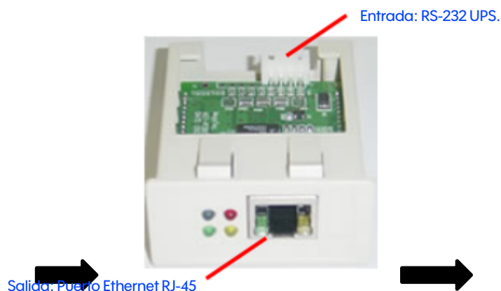
Figura 7. Puertos de Entrada y Salida de la tarjeta X90 de Megatec.
