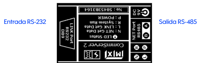
Figura 5. Puertos de Entrada y Salida de la tarjeta X90 de Megatec.
